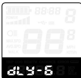
Tempo di ritardo della batteria Interfaccia
